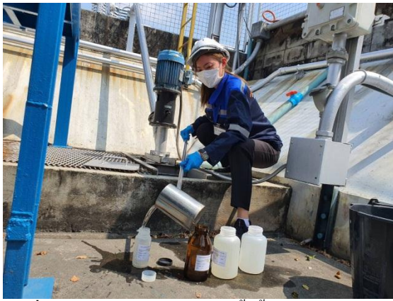
รูปที่ 3.2.1-5 วิธีการเก็บตัวอย่างน้ำทิ้งจากบ่อพักทศใต้
